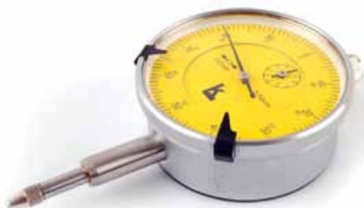
Индикатор часового типа ИЧ предназначен для измерения линейных размеров как абсолютным, так и относительным методами, а также определения величины отклонений от заданной геометрической формы и взаимного расположения поверхностей.
